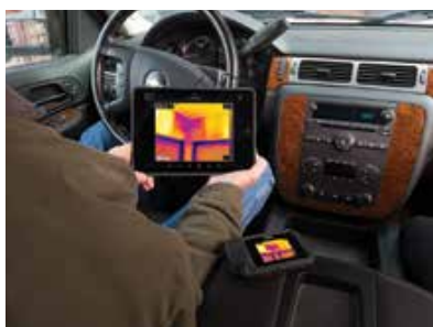
Wysyłanie obrazów do programu FLIR Tools przez Wi-Fi
