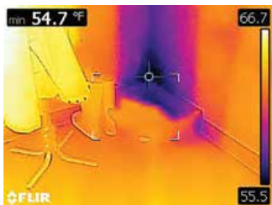
Ramka obszaru z zimnym punktem prezentuje infiltrację powietrza
