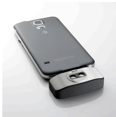
Rysunek 13.3 2015 r.: FLIR One, kamera dla smartfonów iPhone i z systemem Android. Waga: 90 g.
