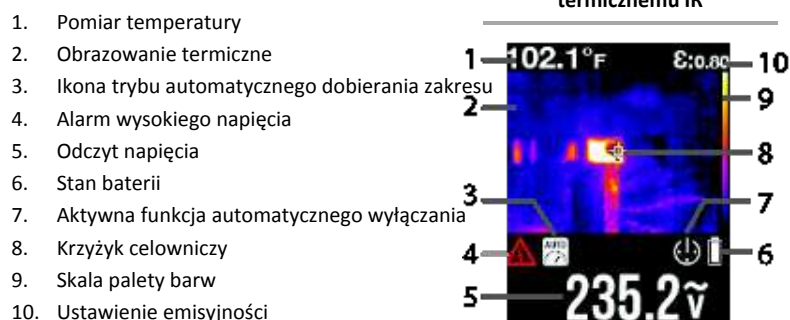
Rys. 5-8 Obraz uzyskany dzięki obrazowaniu termicznemu IR
