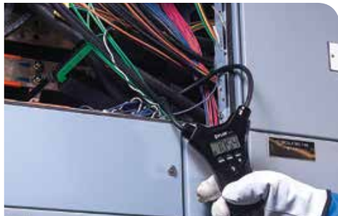
Elastyczny przewód FLIR CM57 przeznaczony do ciasnych miejsc
