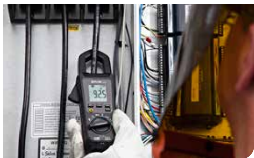
Pomiar rzeczywistej wartości skutecznej prądu zmiennego do 600 A
