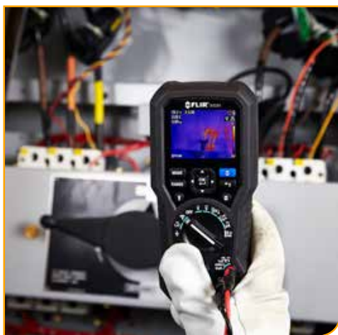
Obraz termiczny tablicy rozdzielczej
