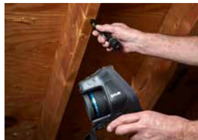
Przy użyciu MR40 można skontrolować, czy zimny punkt na obrazie termowizyjnym to efekt wilgoci
