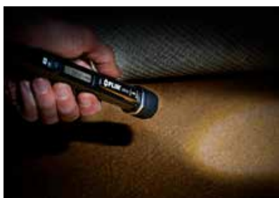
Zintegrowane oświetlenie robocze zastępuje oddzielną latarkę
