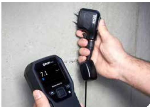
Zewnętrzna sonda kontaktowa do opornościowych pomiarów wilgotności przegrody
