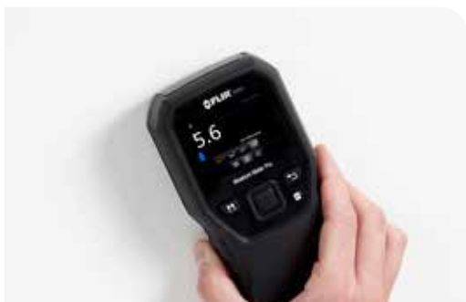
Sprawdzanie wilgotności przegrody za pomocą bezkontaktowego (nieniszczącego) pomiaru
