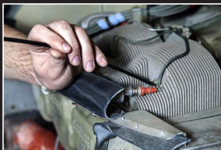
Przegląd cylindra silnika lotniczego przy użyciu aircraft motor with VSA2-1M
