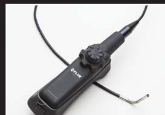
Przeowodwa przegubowa sonda kamery VSA2-1
