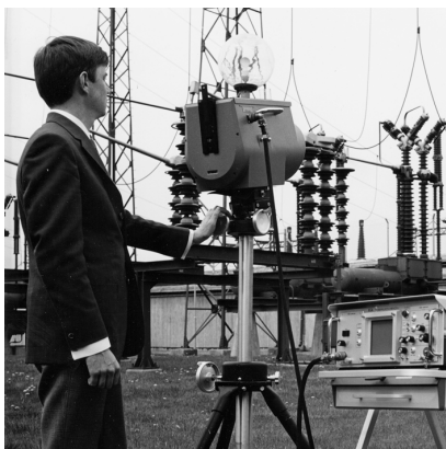
Rysunek 31.2 1969 r.: Thermovision Model 661. Kamera ważyła około 25 kg, oscyloskop — 20 kg, a statyw — 15 kg. Ponadto operatorowi potrzebna była do pracy prądnica prądu przemiennego o napięciu 220 V oraz 10-litrowy zbiornik z ciekłym azotem. Na lewo od oscyloskopu widoczny jest moduł zewnętrzny Polaroid (6 kg).
